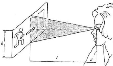
Рисунок В.1 - Определение расстояния распознавания знака безопасности
